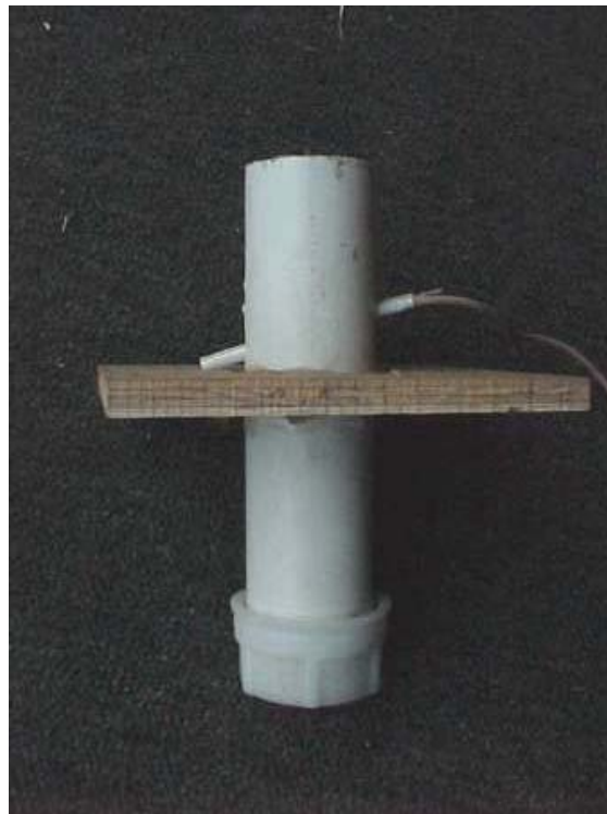
El interruptor flotante terminado
