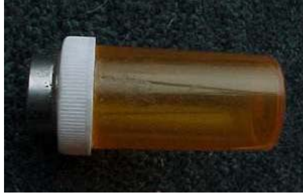
Flotador con el imán pegado a su extremo superior
